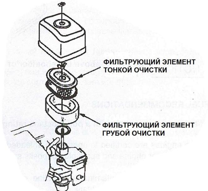
**ЗАМЕЧАНИЕ** Использование двигателя без воздушного фильтра, или с поврежденным воздушном фильтром, приведет к попаданию пыли и загрязнений в двигатель, что в свою очередь сократит срок службы двигателя. Данные тип повреждения не входит в гарантийный ремонт.
