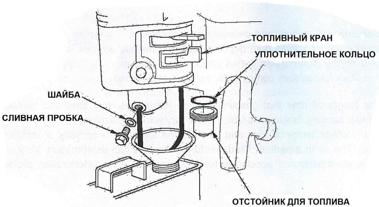
3. После того как бензин полностью слит, установите отстойник для топлива и сливную пробку. Плотно затяните их.
