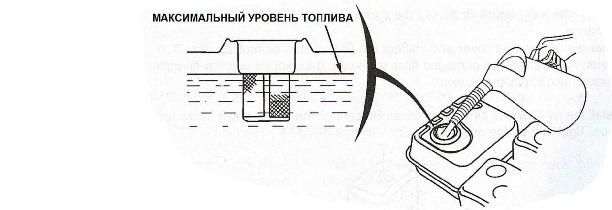
**ЗАМЕЧАНИЕ** Не заполняйте топливо выше топливного фильтра (максимальный уровень топлива)
