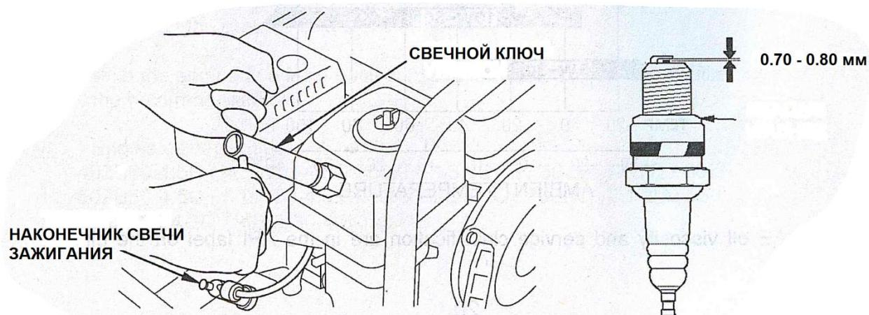
4. Измерьте зазор свечи с помощью толщинометра. Зазор должен составлять 0,7-0,8 мм. Если необходима регулировка, аккуратно изогните боковой электрод.
