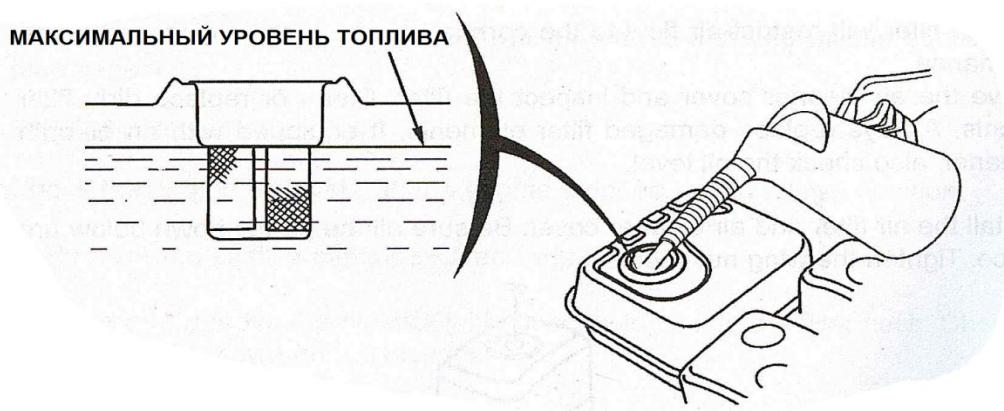
надо проводить в хорошо проветриваемом помещении, прежде чем запустить двигатель.
